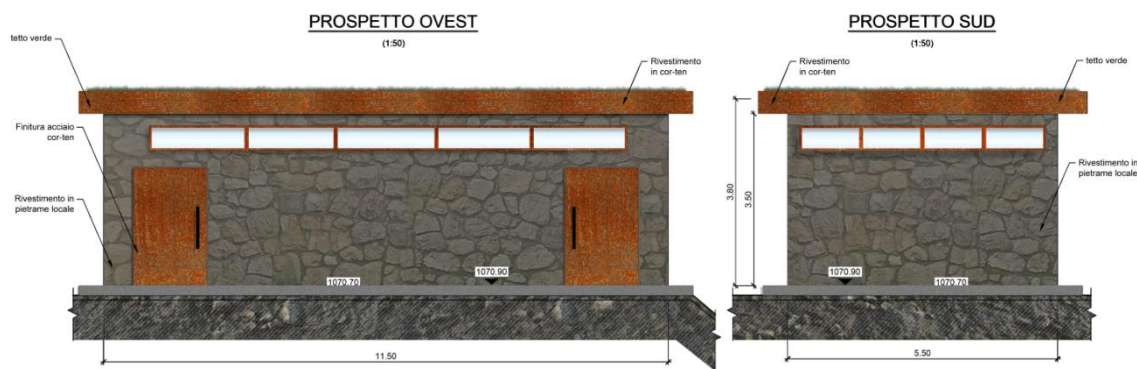
Figura 4-2: Esempio di mascheramento visivo delle cabine di sezionamento (rivestimento in pietra locale, tetto verde, finiture in cor-ten)
